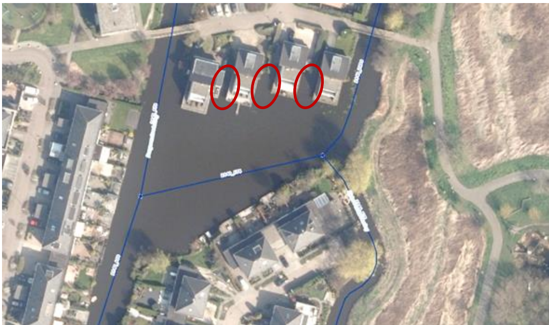
Figuur 3: Niet-lijnvormig primair water in stedelijk gebied met moeilijk bereikbare delen (rood omcirkeld)
