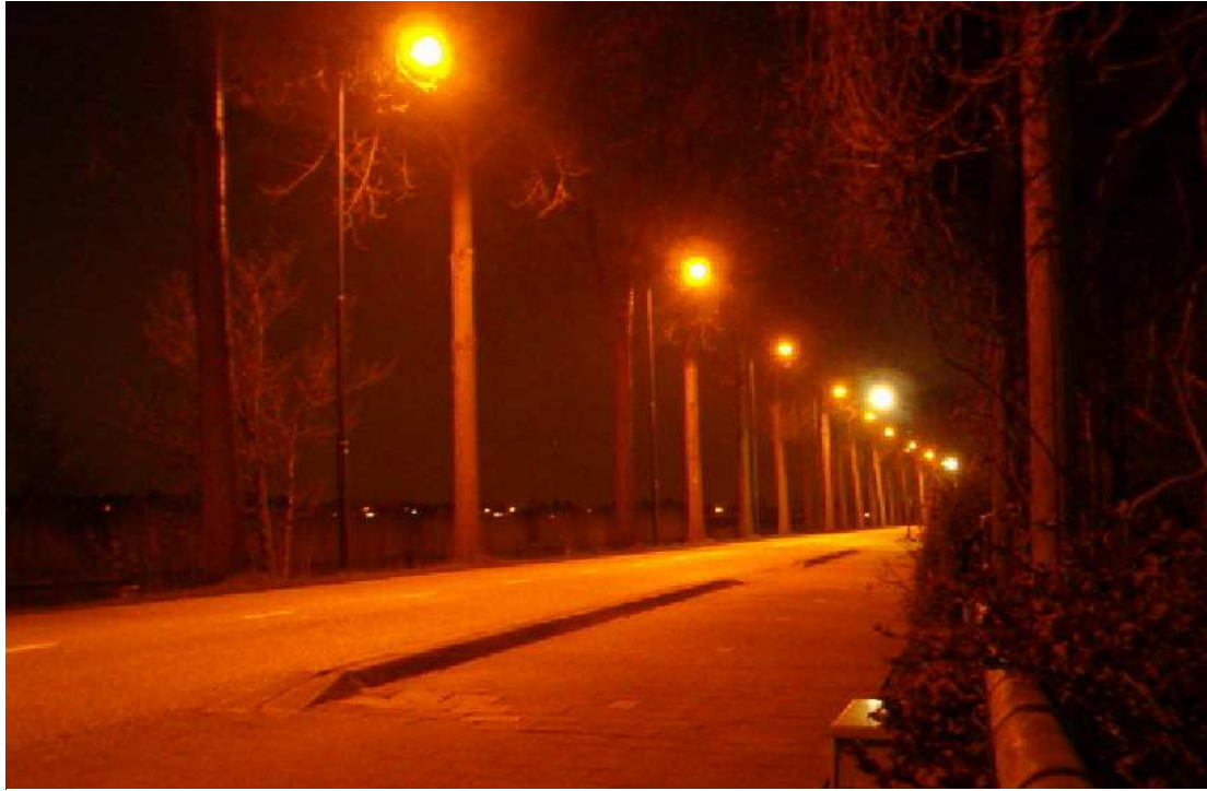
Figuur 3 Een ontsluitingsweg voorzien van lage druk natrium verlichting (geen kleurherkenning)
