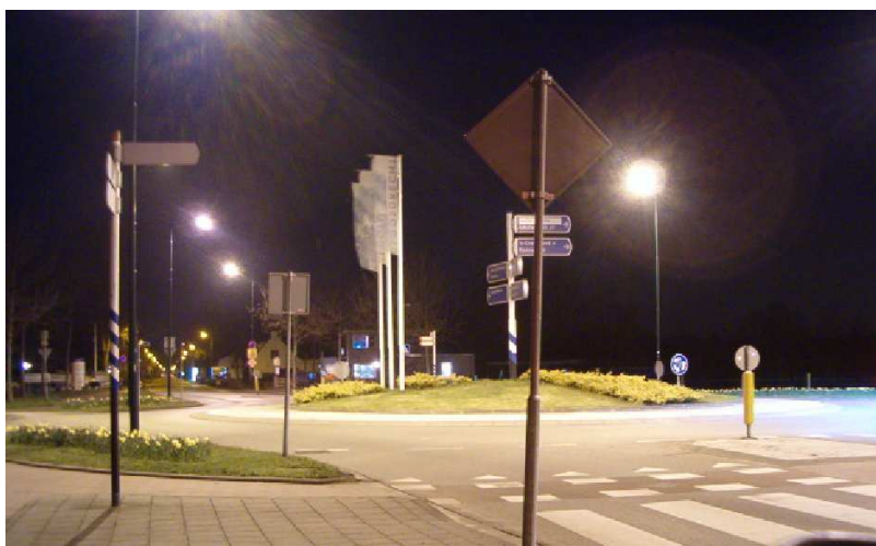
Figuur 2 Een rotonde met hoge druk natrium verlichting (redelijke kleur herkenning)
